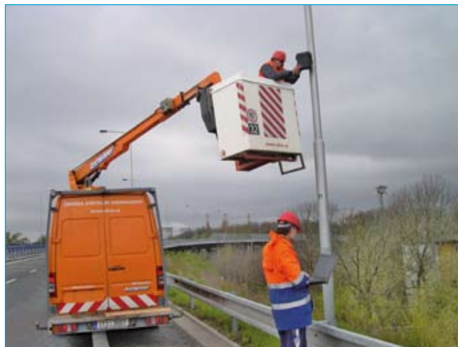
Kalibrace přenosného radarového sčítače PMS - SA4
